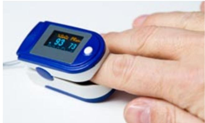
das Pulsoximeter steckt. Über die Anzeige des PI-Wertes kann herausgefunden werden, ob die ermittelten Messwerte für die Sauerstoffsättigung plausibel sind. Angezeigt wird ein PI-Wert zwischen 0 und 20 %. Dieser Wert deutet eine Schwankungsbreite an, die durch den pulsartigen Blutfluss bei einer Pulsoximetermessung entsteht.
